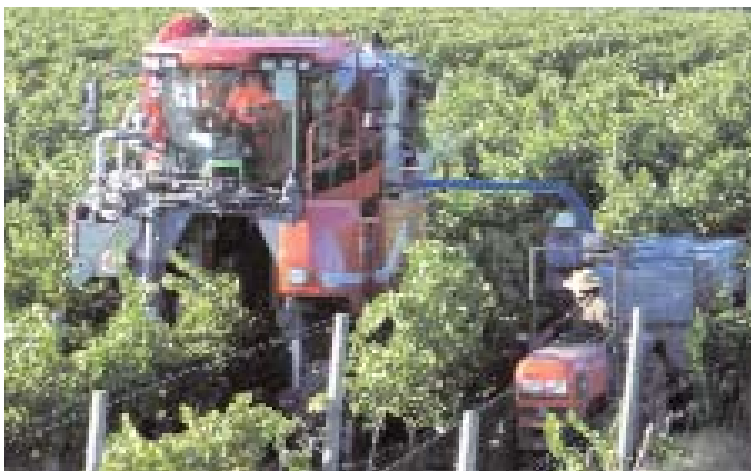
Traubenernteensafter bei der kontinuierlichen Übergabe des Mostes; März 2006, Chile
