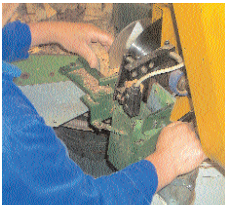
Schneiden der Korkrinde in Streifen zur weiteren Verarbeitung (Fotos: Daniel Pulver, Agroscope FAW Wädenswil)
