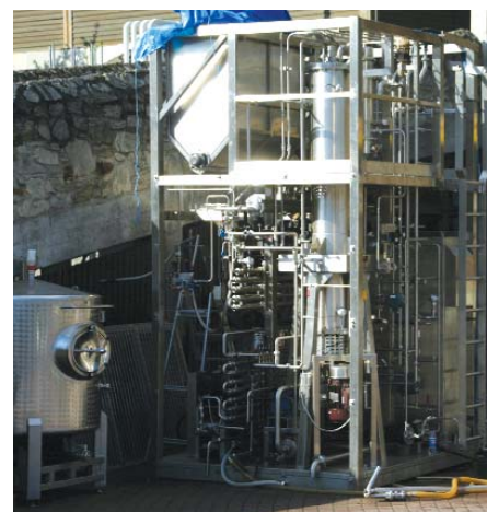
Eine Schleuderkegelkolonne (Spining Cone Column) stand zu Versuchszwecken dem Fachbereich Oenologie in Geisenheim zur Verfügung
